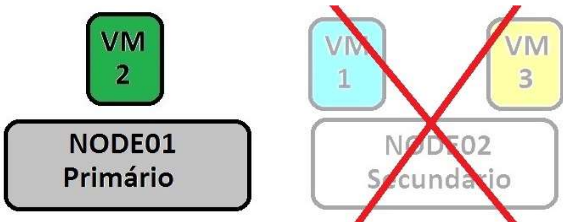
Figura 24 – Estrutura após falha Fonte: Elaborado pelo autor, 2019.
